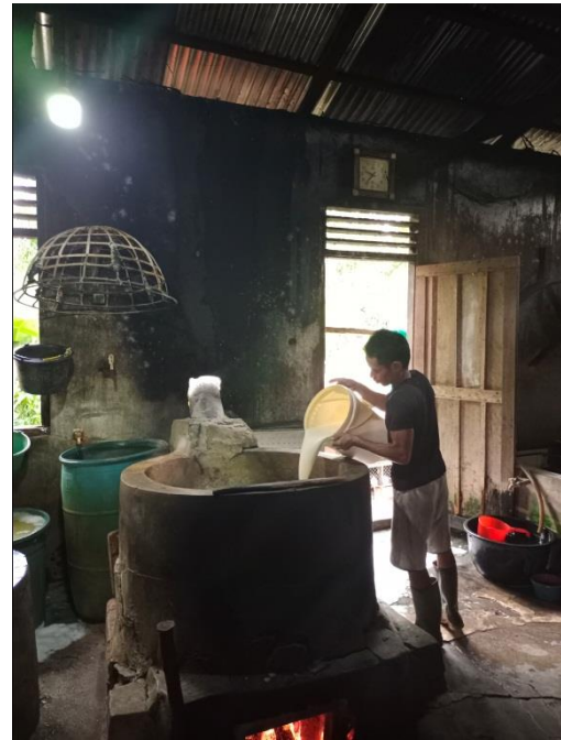
Setelah ditiriskan kacang kedelai digiling hingga menjadi bubur tahu dan dimasak hingga mendidih
