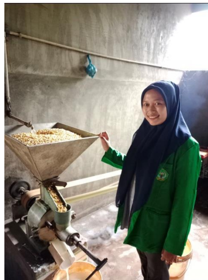
Proses penggilingan kacang kedelai yang sudah direndam dan ditiriskan hingga menjadi bubur kedelai
