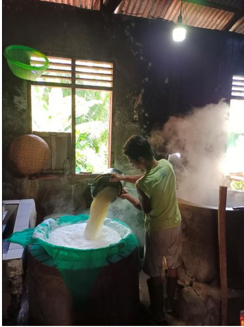
Proses penyaringan agar sari tahu dan ampas tahu terpisah
