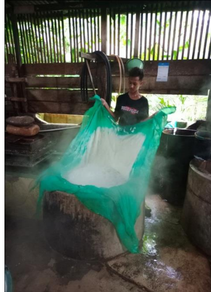
Proses pemindahan bubur tahu yang telah mendidih untuk disaring untuk memisahkan ampas tahu dengan sari tahu tersebut
