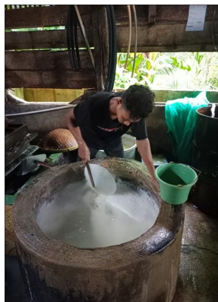
Proses pengobatan sari tahu yang telah terpisah dengan ampasnya menggunakan cuka khusus tahu
