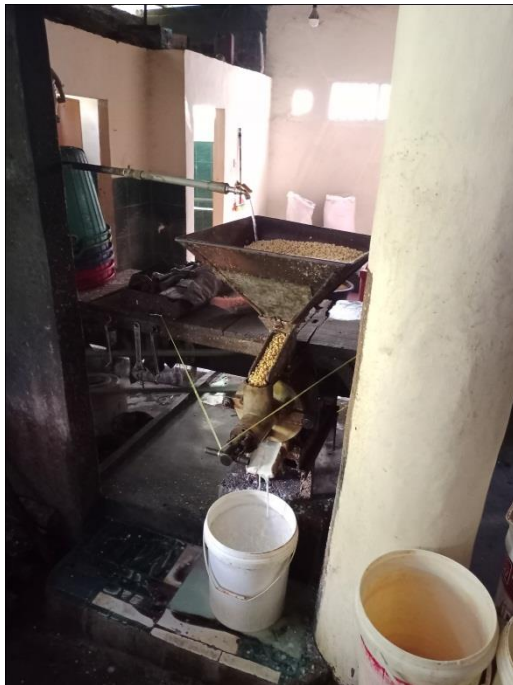
Setelah ditiriskan kacang kedelai digiling hingga menjadi bubur tahu dan dimasak hingga mendidih
