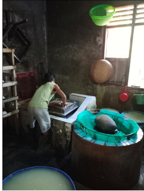
Proses penyaringan agar sari tahu dan ampas tahu terpisah
