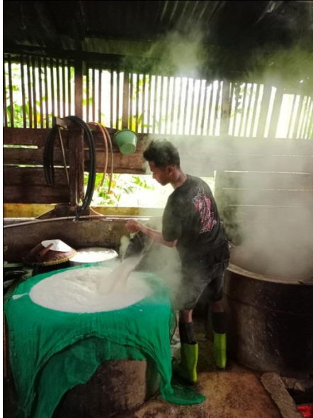
Proses pemindahan bubur tahu yang telah mendidih untuk disaring untuk memisahkan ampas tahu dengan sari tahu tersebut
