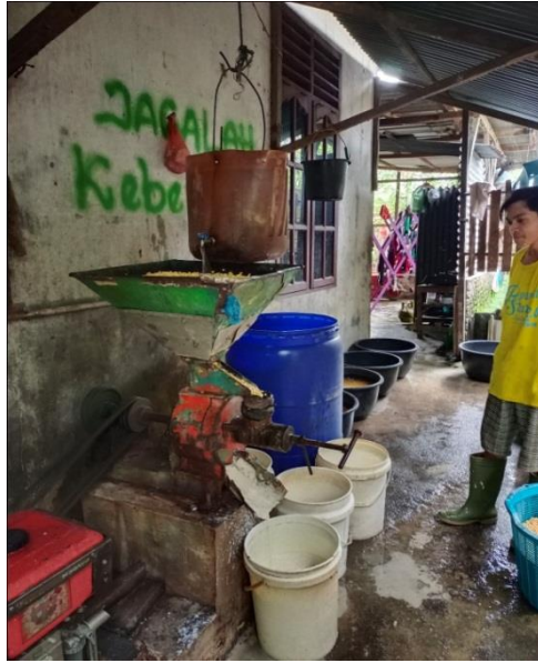
Proses penggilingan kacang kedelai yang sudah ditiriskan hingga menjadi bubur
