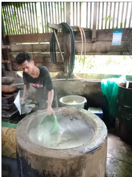
Proses pengobatan sari tahu yang telah terpisah dengan ampasnya menggunakan cuka khusus tahu
