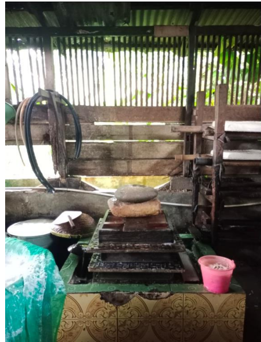
Proses pencetakan tahu lalu disusun tiga tingkat menggunakan batu dan didiamkan selama 30 menit
