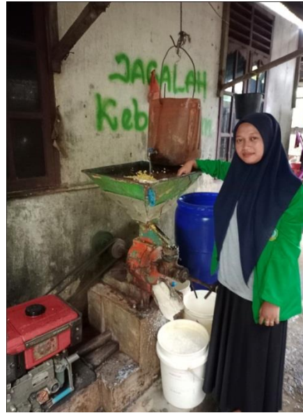
Proses penggilingan kacang kedelai yang sudah ditiriskan hingga menjadi bubur
