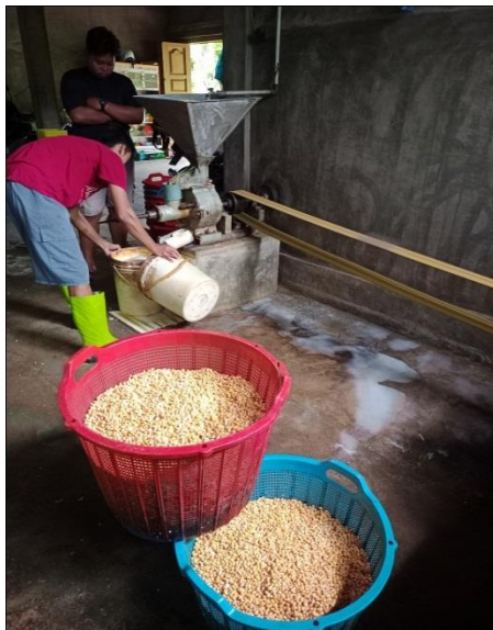
Proses penggilingan kacang kedelai yang sudah direndam dan ditiriskan hingga menjadi bubur kedelai
