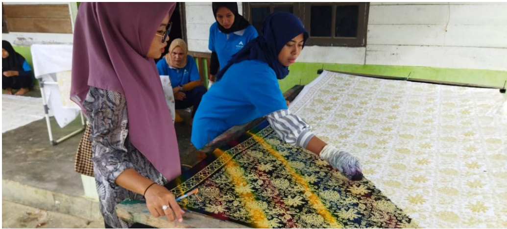
Gambar 4. Proses pewarnaan kain batik cap.
