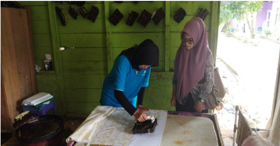
Gambar 2. Proses pembuatan kain batik cap.
