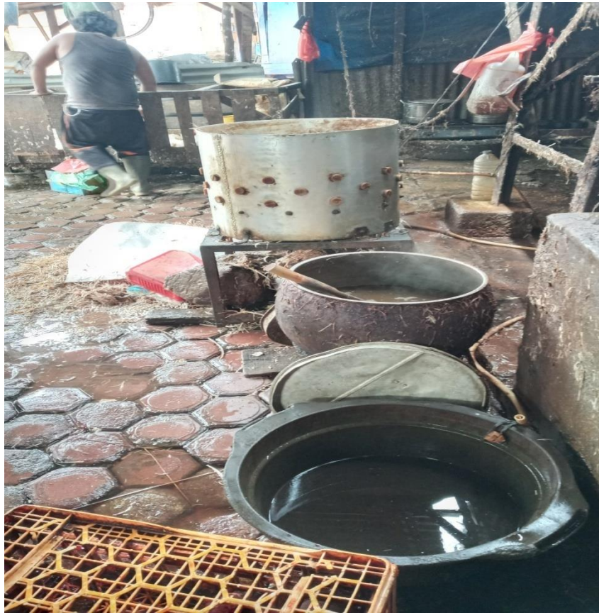
Mesin pencabut bulu ayam dan panci pemanasan air untuk perendaman ayam
