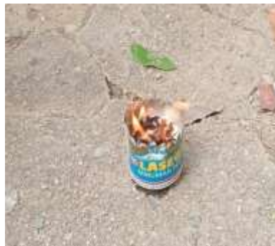
Gambar 9. Hasil lkpd peserta didik, api bertahan kurang lebih 20 menit menggunakan minyak jelantah
