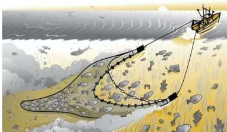
Gambar Ilustrasi Cara Kerja Jaring Hela Ikan Berkantong
